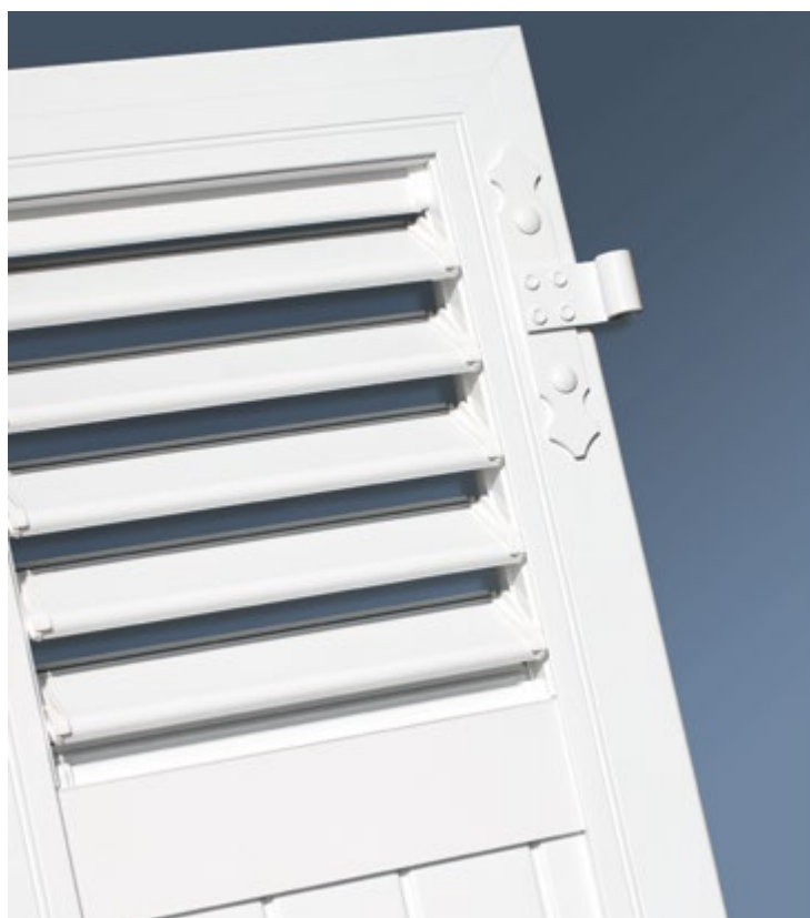
Volet ajouré avec lames extrudées de 47 x 10 Cadre volet de 80 x 33 avec moulure
