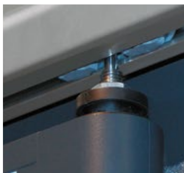
Galet emprisonné sur rail anti-déraillement
